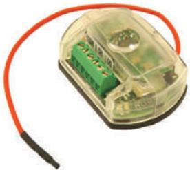
Receptor autónomo bicanal miniaturizado. Funcionamiento monoestable para el primer canal y funcionamiento del segundo canal seleccionable (monoestable, biestable o temporizado a 120 segundos). Posibilidad de activar la función de programación de nuevos códigos de transmisión a distancia.
