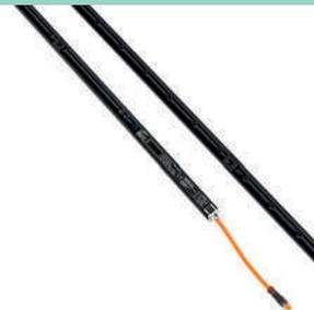
Cortina de luz de seguridad (LIG) compuesta por un transmisor y un receptor, apta para todo tipo de puertas automáticas con un anchura mínima de 1,6m. Cumple con todos los requisitos de seguridad vigentes en la normativa actual. Solo puede detectar objetos que sean 5mm más grandes que la distancia entre haces.
